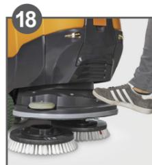
18 Bürsten-/Pad-Teller abnehmen, unter fließendem Wasser reinigen, trocknen lassen
