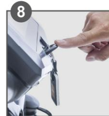
8 Starten Sie die Maschine durch Drücken des NFC-Schlüssels
