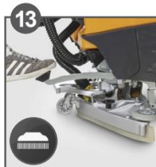
13 Bürsteneinheit anheben (manuell oder automatisch per EBU)
