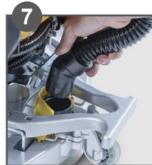
7 Saugbalken montieren und mit dem Absaug Schlauch verbinden
