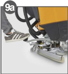
9a Absenken der Bürsteneinheiten mit Hilfe des Fusspedals
