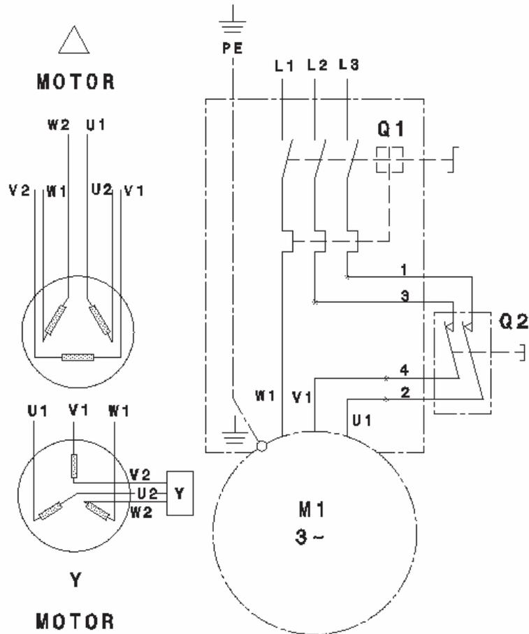
**Q1** — **MOTORSCHUTZSCHALTER MIT ÜBERSTROMSCHUTZ**
