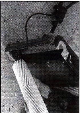
Neue Bürstenwalze mit Verzahnung auf Antrieb aufsetzen
