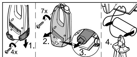
→ Прибор следует открывать только для утилизации аккумулятора.
