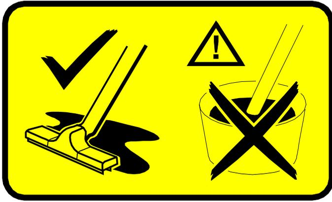
**DE** Verwenden Sie das Gerät nur zum Aufsaugen von verschütteten Flüssigkeiten. Das Gerät ist nicht zum Ansaugen von Flüssigkeiten aus Behältern geeignet.
