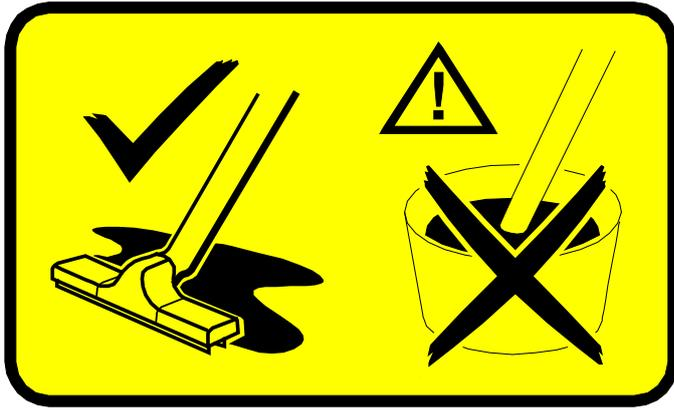
**PL** Urządzenie należy stosować wyłącznie do zasysania rozlanych cieczy. Urządzenie nie jest przeznaczone do zasysania cieczy ze zbiorników.
