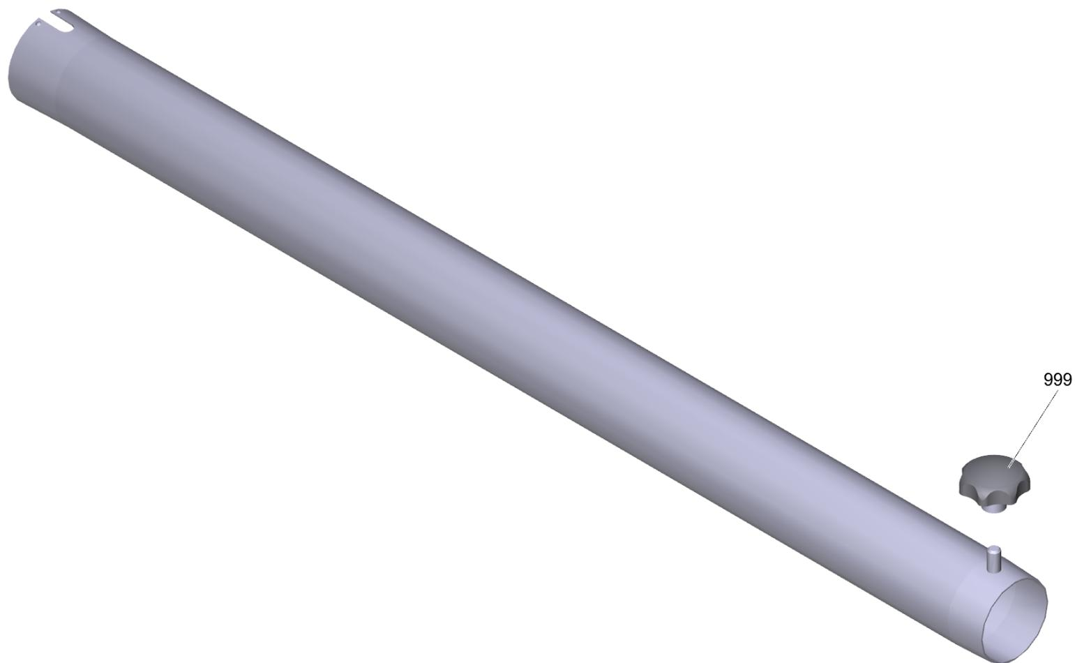
10 Всасывающая труба 850 мм, DN 52 (6.902-181.0)
