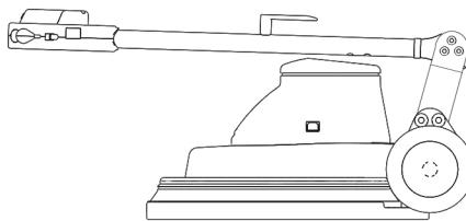
В варианте исполнения 230 В/60 Гц ручка может быть откинута вперед для транспортировки и хранения.
