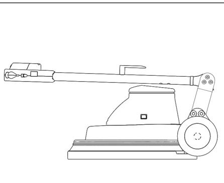
Na variante 230V/60Hz, o manípulo pode ser basculado para a frente, para o transporte e armazenamento.
