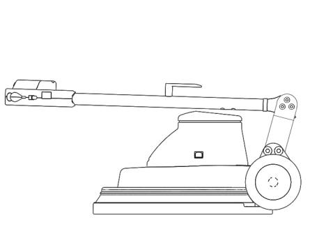
При вариант 230V/60Hz дръжката може да бъде наклонена напред за транспортиране и съхранение.
