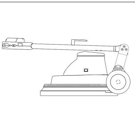
Pour la variante 230V/60Hz, la poignée peut être basculée vers l'avant pour le transport et le stockage.
