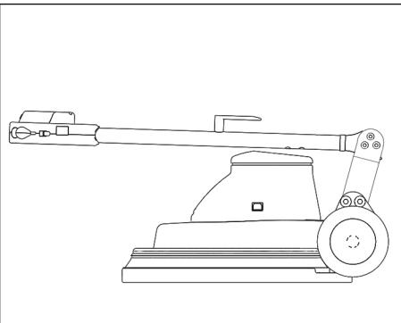
Per la variante da 230V/60Hz il manico può essere orientato in avanti per il trasporto e l'immagazzinamento.
