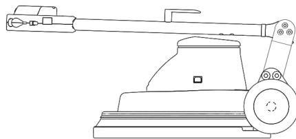
230V/60Hz modelinde, taşıma ve depolama için tutamak öne çevrilebilir.
