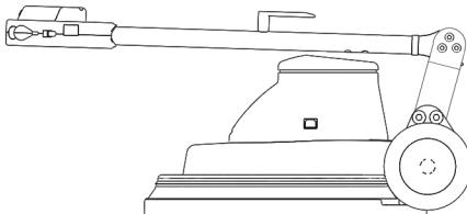
Kod izvedbe 230V/60Hz se radi transporta i skladištenja rukohvat može zakrenuti prema naprijed.
