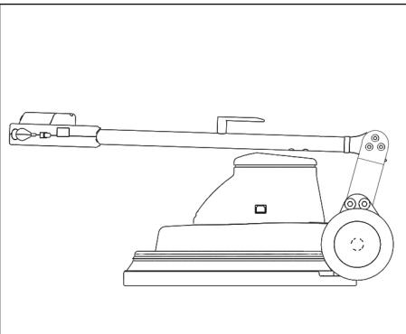
Bei der 230V/60Hz Variante kann zu Transport und Lagerung der Griff nach vorne geschwenkt werden.
