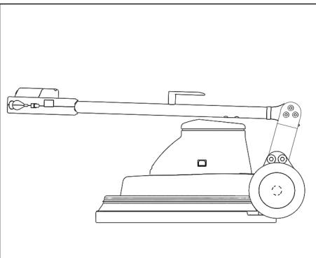
På 230V/60Hz varianten kan håndtaget drejes fremad til transport og opbevaring.
