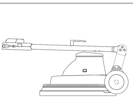
En la variante 230V/60Hz puede bascular el asa hacia delante para transportar y almacenar el aparato.
