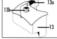
резервуар для грязной воды (13) с «мокрым» фильтром (13a) и поплавком (13b) (в сборе)
