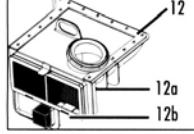
деталь АКВА-фильтра (12) с пористым фильтром (12a) и всасывающим фильтром-кубиком (12b) (в сборе)
