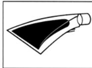
«узкая» моющая насадка для чистки мягкой мебели; имеет собственный кронштейн для закрепления запорного вентиля
