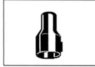
адаптер на случай установки непосредственно на всасывающем шланге насадок, не имеющих собственного кронштейна для закрепления запорного клапана
