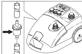
При использовании загрязненной воды фильтр может засориться. Это становится заметно по чрезвычайно длительному запаздыванию в работе насоса или по полному выходу его из строя.
