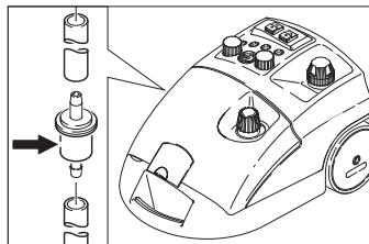
Temizlenmemiş su kullanılması durumunda filtre tıkanabilir. Bu durum, pompanın alıştırmışın dışında uzun süreli çalışması ya da komple fonksiyon kesintisinde kendini belli eder.
