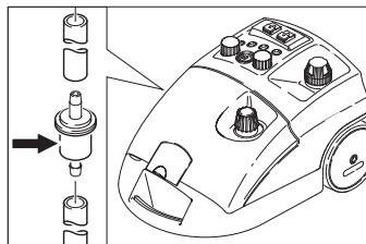
Prilikom primjene onečišćene vode filter se može začeputi. To se može primijetiti u izvanredno dugim razdobljima rada pumpe ili u potpunom prekidu rada.
