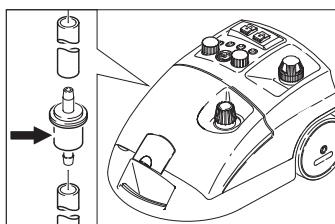
Použijete-li znečistěnou vodu, může dojít k upcání filtru. To je patrné na základě obzvlášť dlouhých provozních dob čerpadla nebo na základě celkové nefunkčnosti přístroje.
