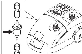
Bei Verwendung von verunreinigtem Wasser kann der Filter verstopfen. Dies macht sich mit außergewöhnlich langen Laufzeiten der Pumpe oder vollständigem Funktionsausfall bemerkbar.
