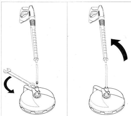
→ Стальную трубу чистящей установки высокого давления подключить к FR Basic и затянуть гаечным ключом (ширина ключа 24).
