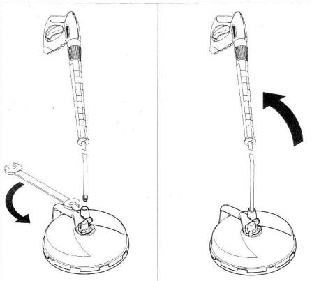
→ Strahlrohr des Hochdruckreinigers am FR Basic anschließen und mit Schraubenschlüssen (Schlüsselweite 24) festziehen.
