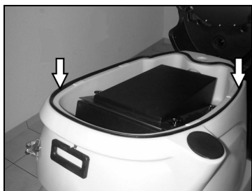
Junta de la tapadera del filtro de polvo
