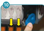
Включить функцию подачи моющего раствора, а также функцию всасывания (правая и средняя кнопки на панели управления).
