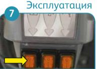
Включить машину, нажав на левую кнопку на панели управления.
