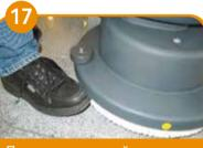
Поднять щеточный механизм и снять моющую щетку, повернув ее против часовой стрелки. Промыть щетку и высушить ее.
