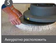
моющие щетки непосредственно под поднятым щеточным механизмом.
