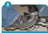
Нажать на педаль щеточного блока и плавно опустить его для установки щетки.
