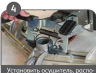
Установить осушитель, расположив его под держателем и опустив держатель «до щелчка». Затем вставить всасывающий шланг в разъем
