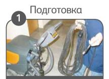
Убедиться, что машина отключена от электросети. Проверить оборудование, особенно вилку и кабель. Запрещается эксплуатация машины при поврежденном кабеле!
