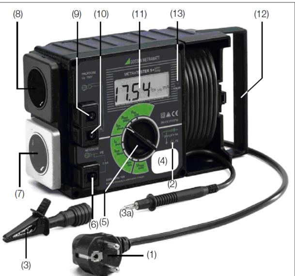
(2) Signallampe PE zur Prüfung des Netzschutzeiters
