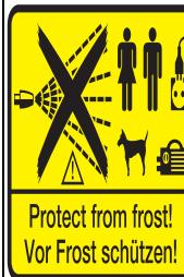
Hochdruckstrahlen können bei unsachgemäßem Gebrauch gefährlich sein. Der Strahl darf nicht auf Personen, Tiere, aktive elektrische Ausrüstung oder auf das Gerät selbst gerichtet werden.
