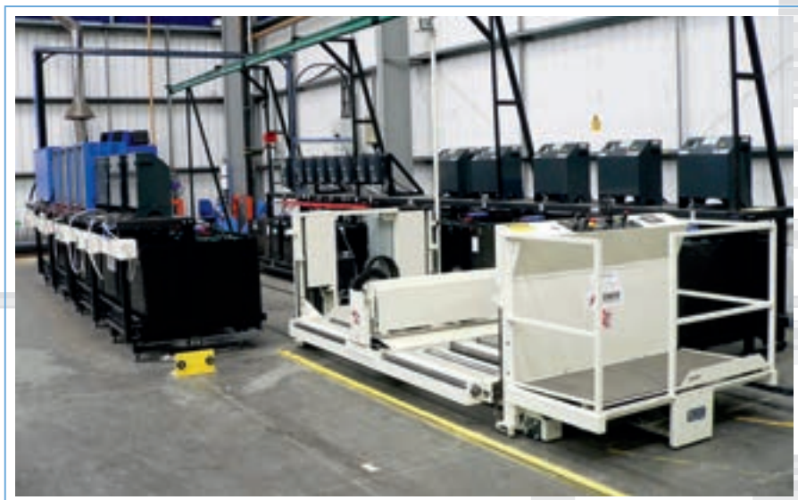
Система автоматизированной замены батарей
