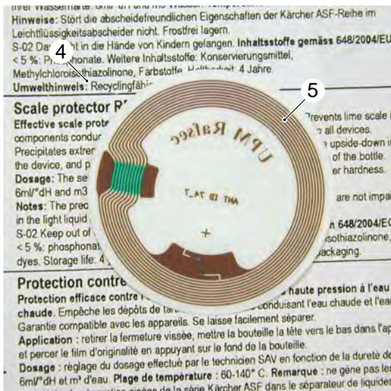
RFID tag, underneath the label
