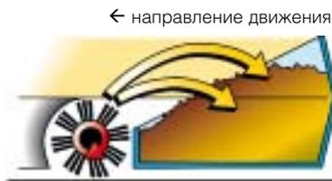
Принцип перебрасывания: степень заполнения бункера 85 – 100 %
