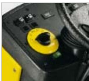
**Цилиндрическая щетка с функцией Eсо:** простое нажатие кнопки обеспечивает переключение режимов фиксированной установки и качающейся подвески щетки. После остановки машины автоматически включается фиксированный режим, отличающийся меньшим износом щетины.
