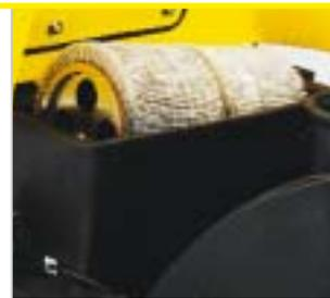
Гидравлический привод боковой и цилиндрической щеток в сочетании с пневматическим управлением ими уменьшает объем технического обслуживания и снижает вероятность выхода из строя. При отключении двигателя автоматически активируется стояночная тормозная система.
