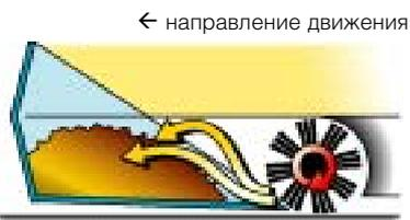
Принцип совкового подметания: степень заполнения бункера 40 – 50 %
