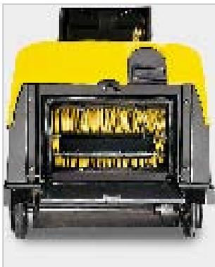
3-колесное шасси, оснащенное ведущим мостом с дифференциалом, и пневматическое управление цилиндрической и боковой щетками превращают KMR 1050 S в машину универсального применения.
