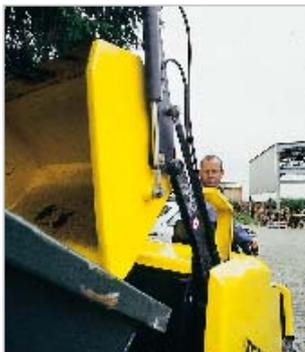
**Все функции**, в т. ч. управления ходовой частью, **инициируются гидроприводами**. Скорость движения передним и задним ходом регулируется педалями. Это **облегчает управление** машиной и **минимизирует объем технического обслуживания**.
